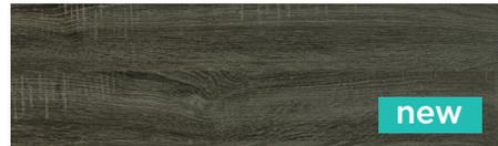
Благодаря меламиновой пропитке ЛДСП приобретает особые свойства. Например, становится более устойчивым к влажности или колебаниям температур. Кроме того, его труднее повредить механическим способом. У данного материала очень эстетичный вид, он долговечен.
